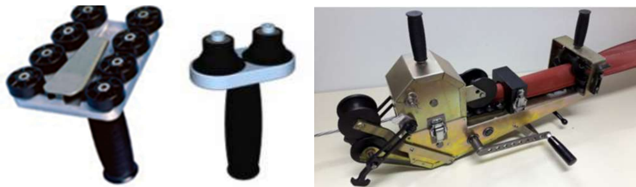
Figura 12 - Desenho Ilustrativo: Ferramentas auxiliares de instalação de proteções Isolantes
